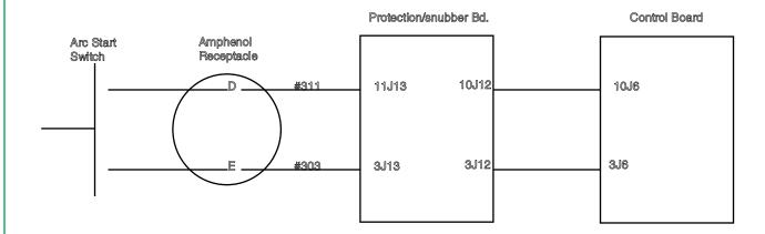
FIGURE F.10 - ARC START TRIGGER CIRCUIT.
